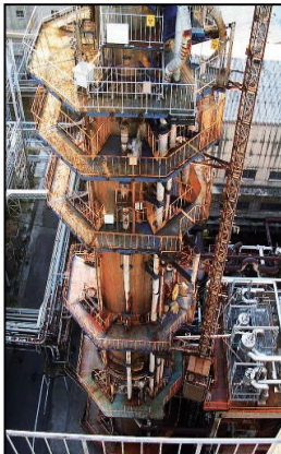
針葉樹蒸解釜の全景。 上部からチップを流し、 最下部で繊維を取り出す工程
